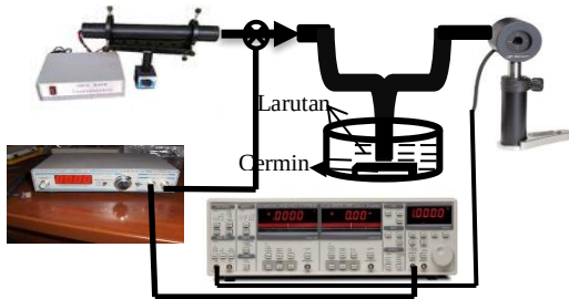
Gambar 2. Sensor serat optik menggunakan serat bundle
